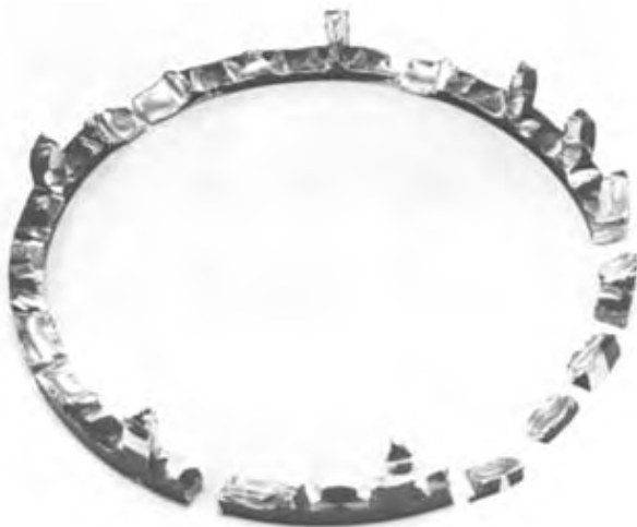
FIG. 4.5 (2342-32C) CAGE BREAKAGE
