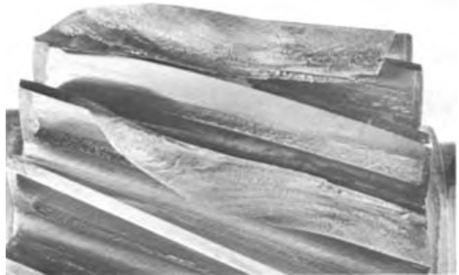
FIG. 2.40 (683-5) TOOTH FRACTURE (ROOT FILLET FATIGUE)
